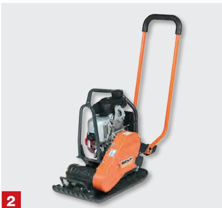
**Einsatz der Rüttelplatte** Unterschätzen solltest du auf keinen Fall die Bedeutung des Abrüttelns der einzelnen Schichten. Beide Tragschichten trägst du in 2 bis 3 Lagen auf und rüttelst jede Lage 2- bis 3-mal ab. Ein Mietgerät bekommst du bei toom.
